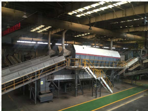
光电智能化分选设施 Intelligent sorting system
